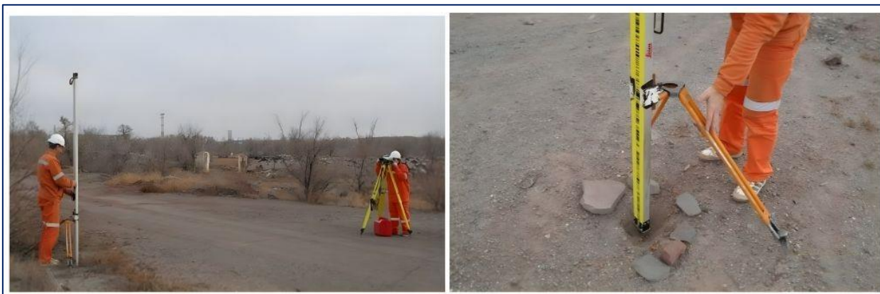
Рисунок 2 – Замер оседания земной поверхности по реперу
