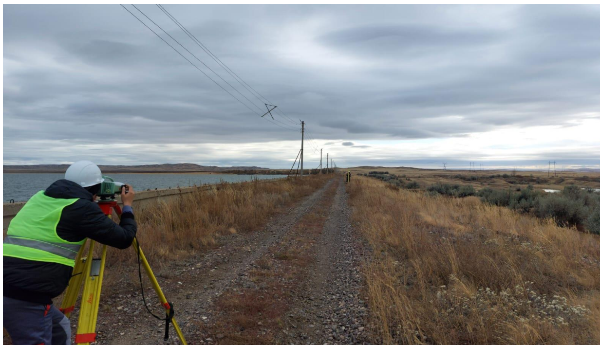
2-сурет - Жер плотинасын жоғары дәлдікпен нивелирлеу
