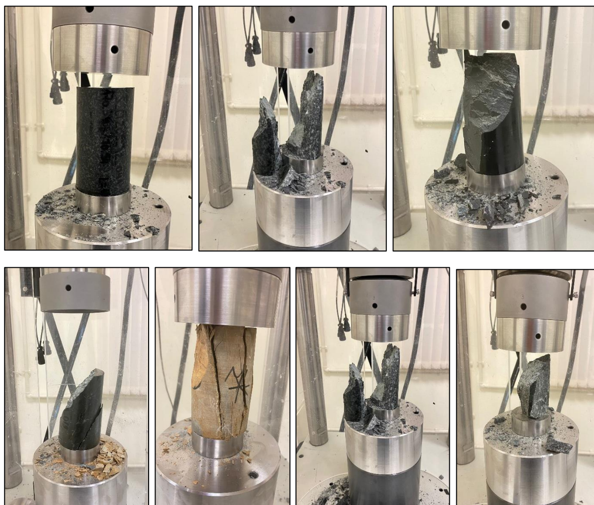
Рисунок 1 – Разрушенные образцы горных пород
