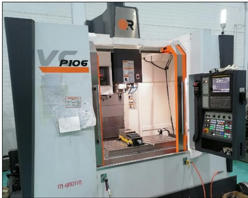
Рисунок 1 – Вертикальный обрабатывающий центр (V-Center P76) с ЧПУ
