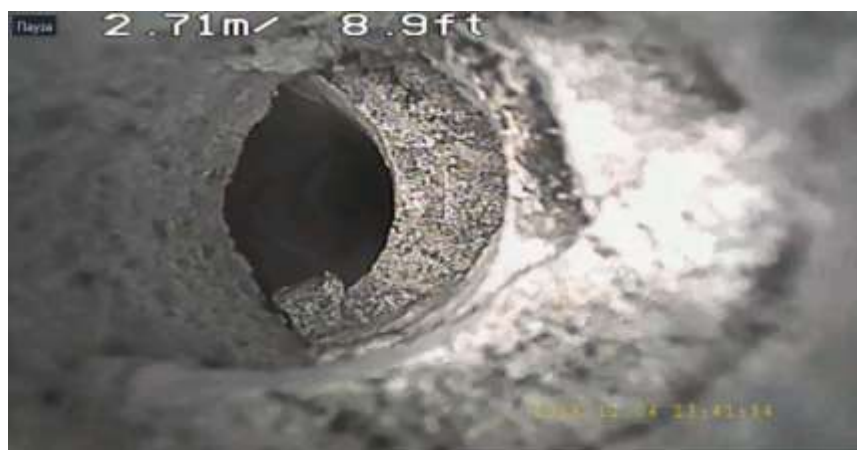
Сурет 2.20 – Қарағанды көмір бассейні «Шахтинская» шахтасы 28д 1-2 желдету штрегінің сол жақ бүйірінен қазба төбесіндегі теспенің эндоскоппен жасалған бейнетүсірілімі
