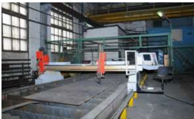
Қарағанды машина жасау конкорциумының металл конструкцияларының элементтерін пішуге арналған микропроцессорлық басқарудағы автоматтандырылған желі
