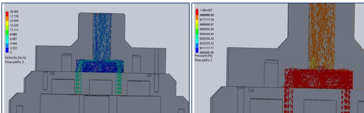
4-сурет - Коллектордағы 15 мм өтпелі радиуста сұйықтық жылдамдығын (А) және қысымды (б) бөлу
