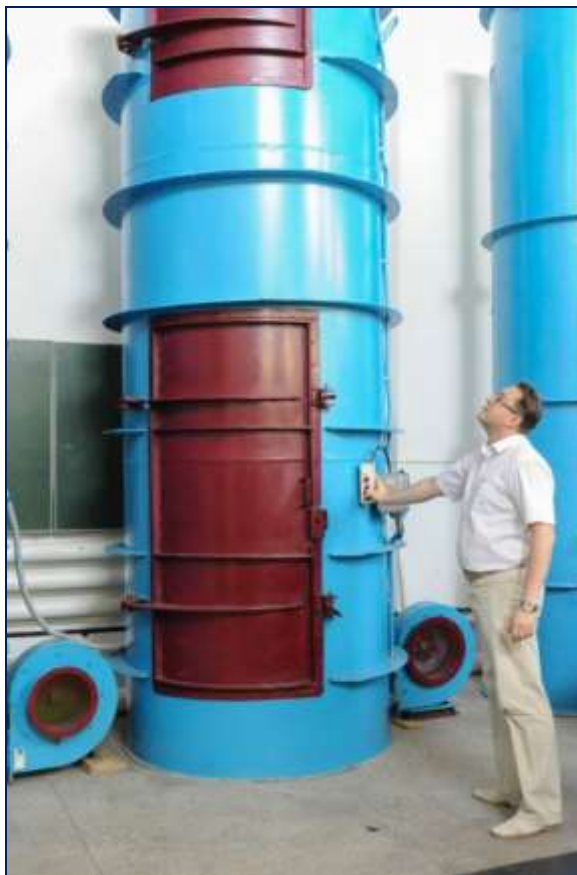
1-сурет – Ғимараттар мен құрылғылар үшін жүк таситын пневмолифтісінің тәжірибелік-өнеркәсіптік үлгісі
