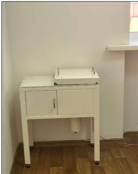
2-сурет – МКС-01А «МУЛЬТИРАД» спектрометриялық орнату
