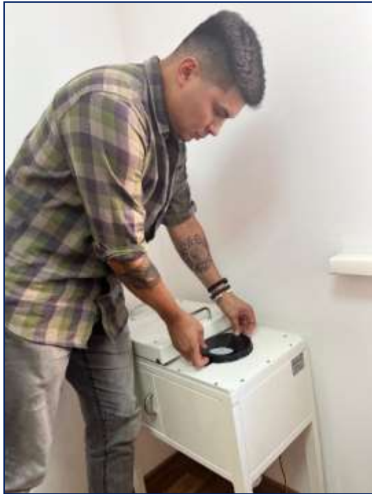
1-сурет – Көмір сынамаларының табиғи радиоактивті нуклидтерінің үлестік белсенділігін анықтау
