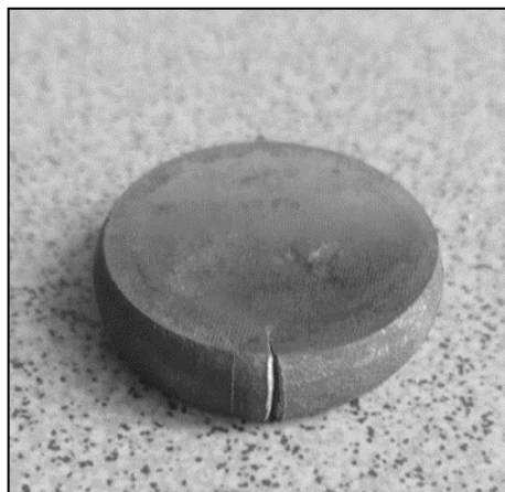
Рисунок 4 – Опытные образцы до и после испытаний на сжатие
