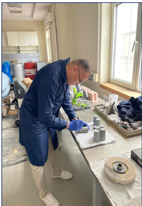
1-сурет – Бір осьті сығымдауға тау жыныстарының (кernнің) беріктігін анықтау үшін өзектерді дайындау
