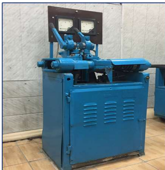
Рисунок 1 – Процесс стыковой контактной сварки на машине «МСП-25»
