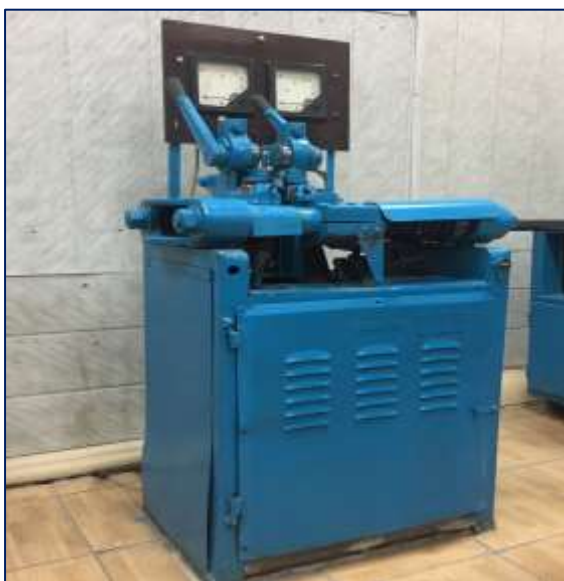
Сурет 1 – Түйістіріп дәнекерлеу үрдісі
