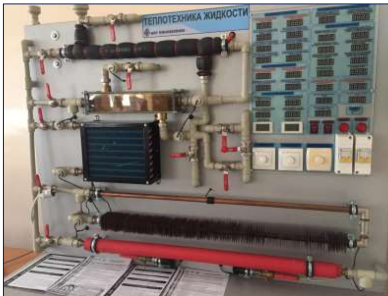
Рисунок 1 – Испытательный лабораторный стенд по изучению теплотехники жидкости, состоящий из трубопровода с тепловой изоляцией
