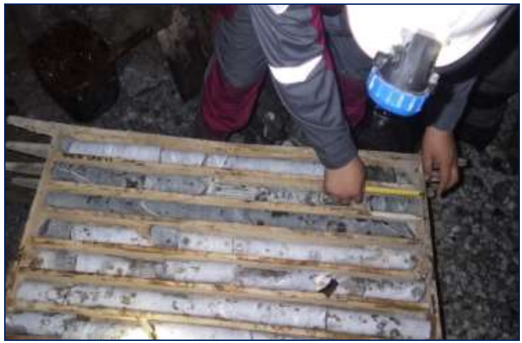
2-сурет – «Жолымбет» кен орнында RQD анықтау үшін алынған үлгі өзектерді өлшеу
