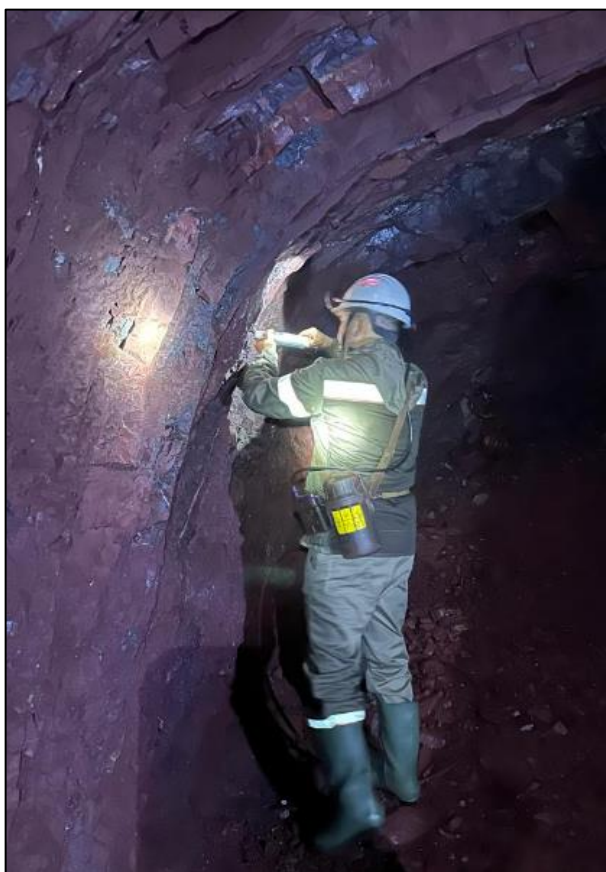
Рисунок 1 – Определение прочности нетронутого массива (IRS) в горных выработках с помощью молотка Шмидта
