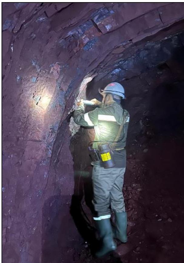
1-сурет – Тау-кен қазбаларында Шмидт балғасының көмегімен таза массивтің беріктігін анықтау (IRS)
