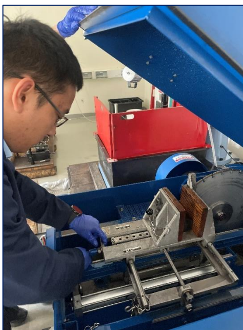
2-сурет – Керн бойынша үлгілерді сынау
