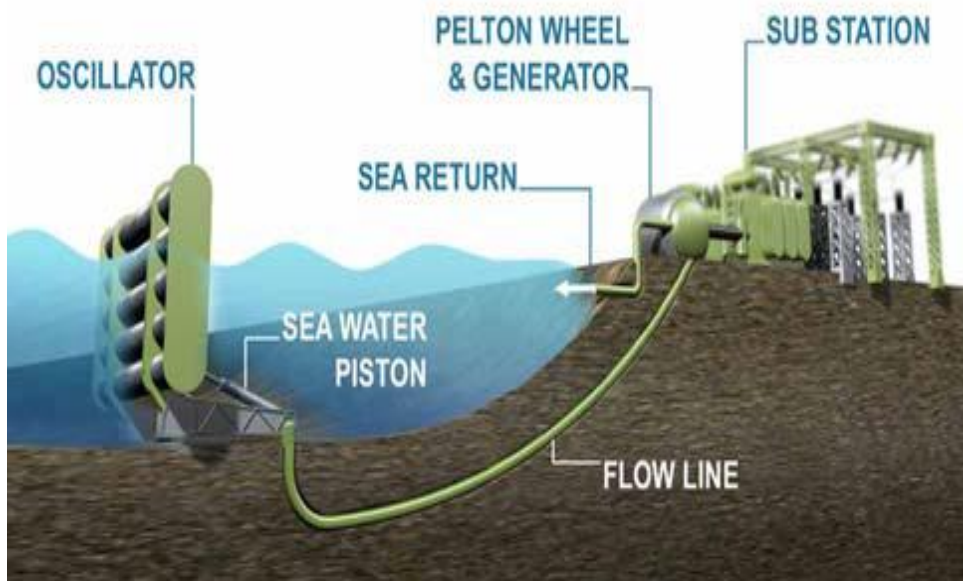
1.2 сурет – Oyster толқындық электр станциясы [43]
