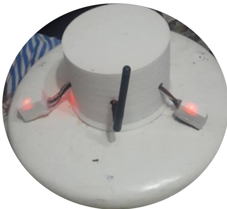
4.2 сурет –Өлшеу аппаратурасы бар қалтқы
